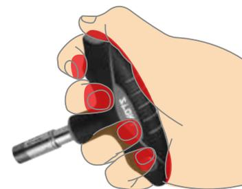
Der T - Handgriff wird benötigt, wenn besonders hohe Drehmomente zu lösen oder festzuziehen sind.
